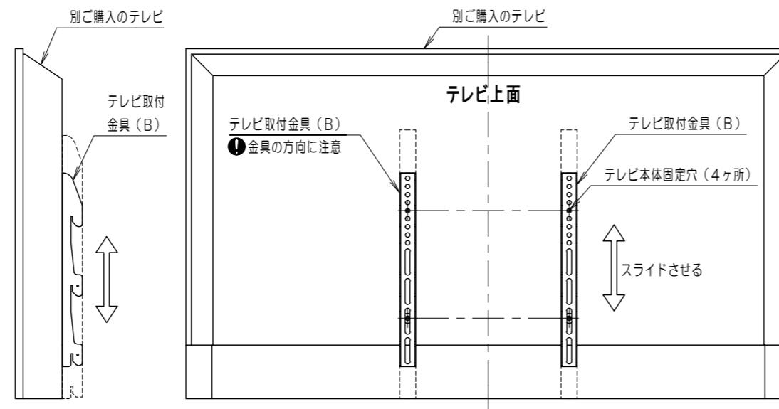
○ テレビの設置高さの目安（下図）を参考に、テレビ取付金具（B）をご希望の高さの位置でテレビ本体の金具穴に固定してください。
