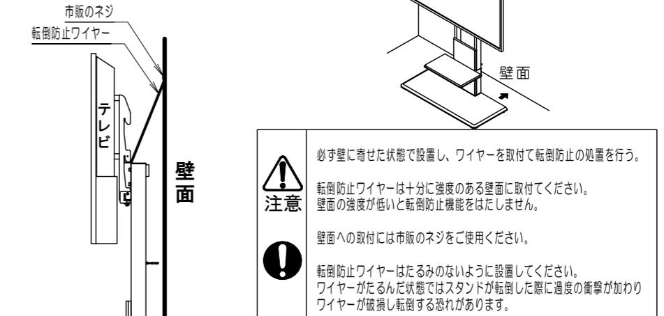
注意 必ず壁に寄せた状態で設置し、ワイヤーを取付で転倒防止の処置を行う。
