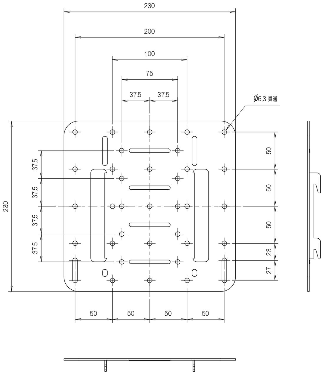
YFST2432 テレビ取付金具B 孔寸法図
