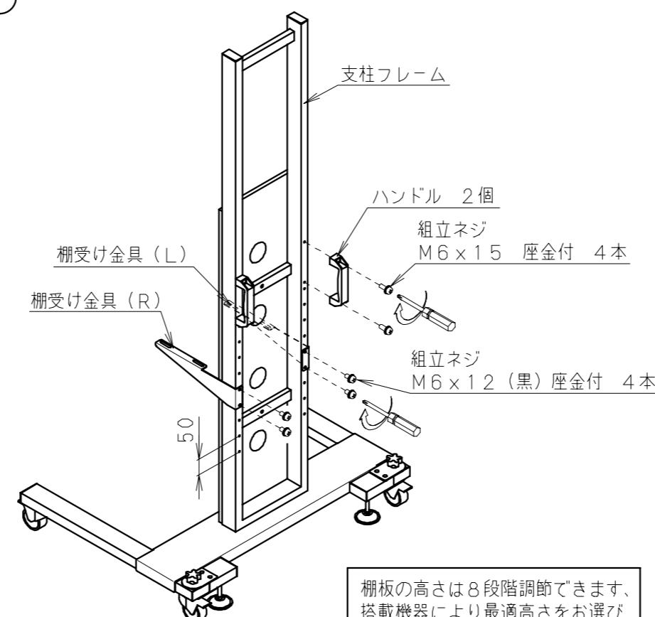
棚板の高さは8段階調節できます、搭載機器により最適高さをお選びください。
