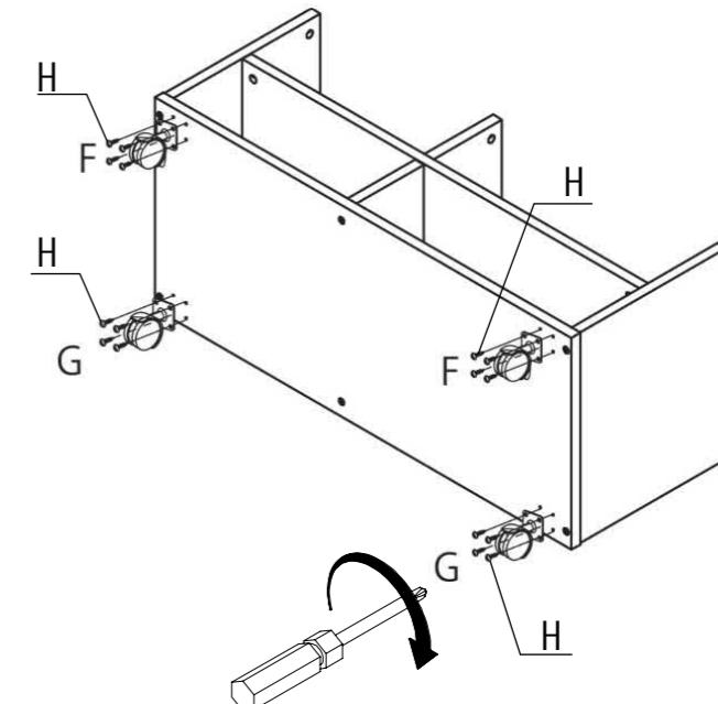
**6** 側板と仕切板に木ダボとカムロック（受け）を取付けて天板を取り付けます。
