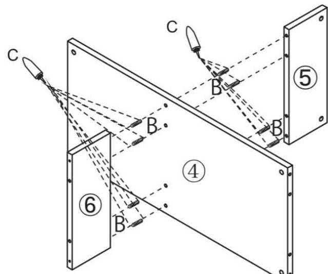
**4** 側板・仕切板の下面に木ダボを入れて、底板を取り付けます。
