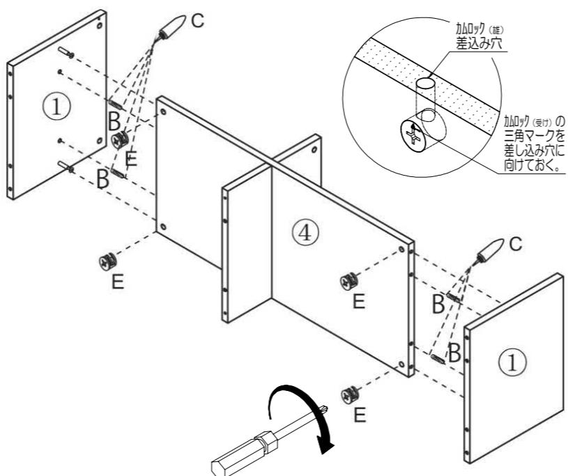
**注意** カムロック（受け）の締め付けをする際、必ず90度から180度の範囲で締め付けてください。
