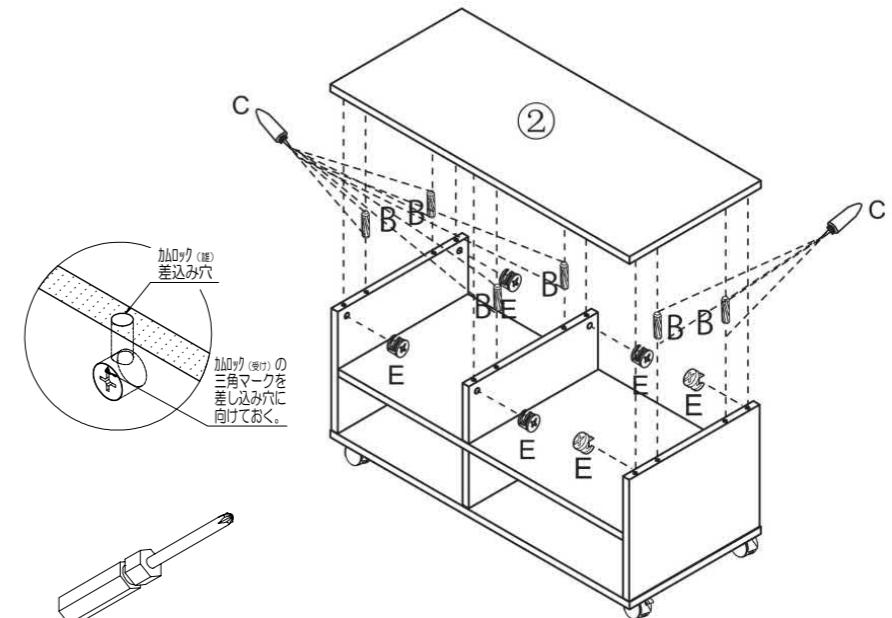
**注意** カムロック（受け）の締め付けをする際、必ず90度から180度の範囲で締め付けてください。
