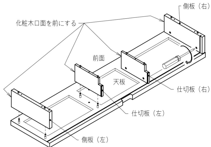
※ 天板に付けたシャフトに側板(左、右)、仕切板(左、右)を差し込み、ジョイント金具(カム)をしっかりと締め付けてください。
