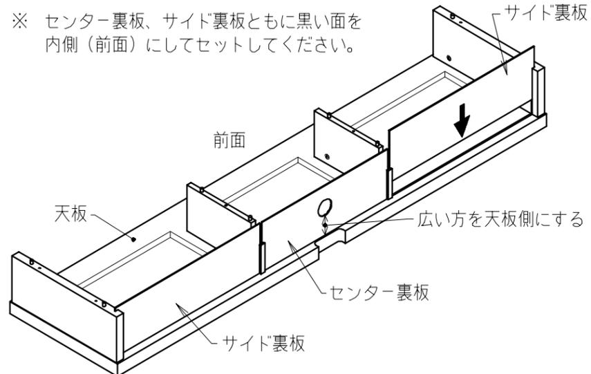
※ センター裏板、サイド裏板(2枚)の黒い面を内側(前面)にして、側板、仕切板の溝に差し込み天板の溝まで押し込んでください。
