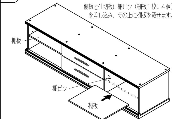
※ 棚板は3段階可変出来ます、搭載機器等により最適位置をお選びください。
