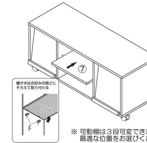
※可動棚は3段可変できます。搭載機器等により最適な位置をお選びください。
