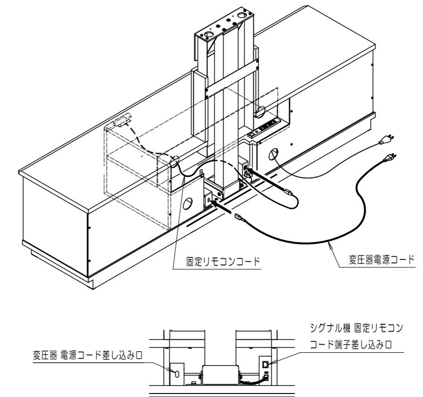
8 電動昇降ユニット梱包内のシグナル機と変圧器を接続し、中央のボックス内に収めます。
