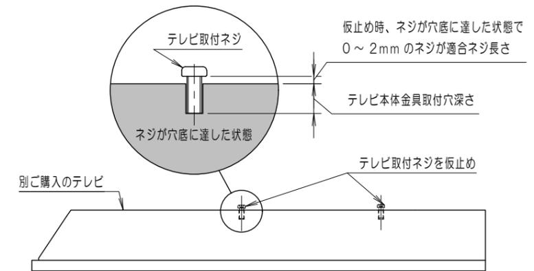
テレビ本体にネジを仮止めし、上図の寸法(0~2mm)に適合したネジをご使用ください。
